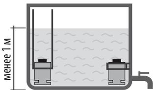
При монтаже в транспортном средстве жестко закрепите устройство к корпусу емкости. Используйте кронштейны и иные приспособления. Это предотвратит изменение положения водонагревателя при движении транспортного средства. Нагрев воды возможен при движении транспортного средства, если уровень воды в баке более 50%.
