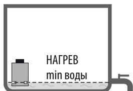
Погрузить устройство в емкость с водой так, что бы уровень воды был выше датчика уровня воды. Чем ниже устройство будет погружено в емкость, тем равномернее будет вода прогреваться. Предусмотрите перемешивание воды. Допустимо погружение устройства на глубину до 1 м.
