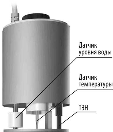
Датчик уровня воды ④ не позволит включить ТЭН, если вода отсутствует или уровень воды ниже герметичного отсека. Налейте воду. После того как вода будет подогрета до заданной температуры, отключится напряжение от ТЭНа ②.
