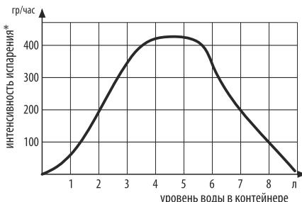
\*интенсивность испарения гр/час при  $t= 25^{\circ}\text{C}$ , начальная влажность RH-10%, максимальные обороты вентилятора.
