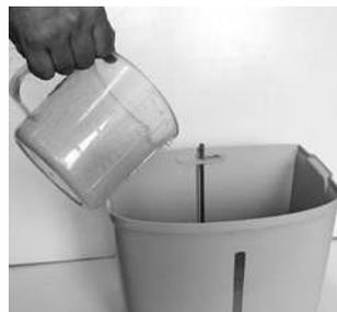
Налейте воду в контейнер. Температура воды должна быть **не более 40°C**. Добавьте средство для удаления отложений. Размешайте средство до полного растворения. Установите барабан с дисками в контейнер с водой и средством для удаления отложений. Диски барабана должны быть полностью покрыты водой. Через 24 часа слейте всю воду, сполосните барабан с дисками и контейнер чистой водой.
