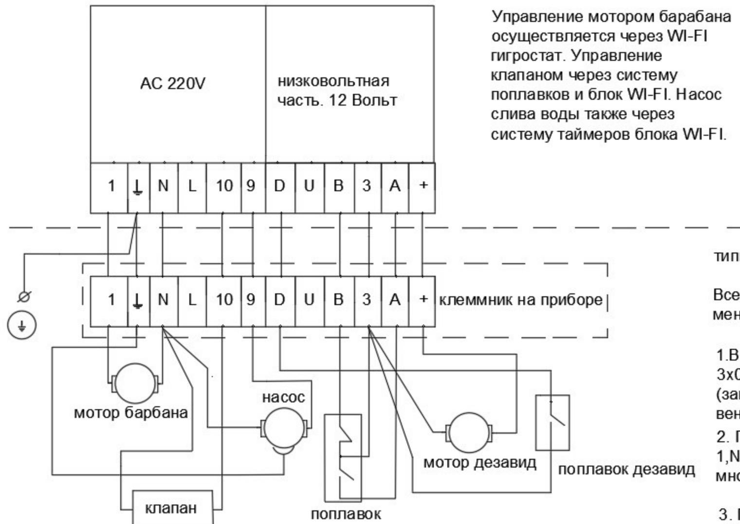
СХЕМА ЭЛЕКТРИЧЕСКАЯ МОНТАЖНАЯ
