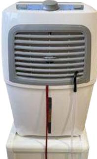
7. Проследите за тем, чтобы максимальный уровень жидкости в емкости для забора воды не был выше уровня среза крючка подающей трубы, в противном случае, после выключения насоса, возможен самотек воды в увлажнитель до момента выравнивания уровней.
