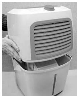
Включите устройство. Установите минимальные обороты вентилятора. Через 24 часа слейте всю воду, сполосните барабан с дисками и контейнер чистой водой.
