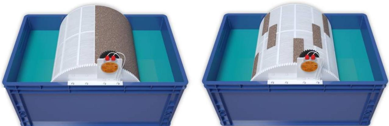
7.5 ) Через 4 часа повернуть барабаны на 120°. Если концентрация щавелевой кислоты достаточная вы должны увидеть разницу. Через 4 часа снова повернуть барабаны на 120°. Если соли и ржавчина плохо отмылись подвергните данные участки более длительному замачиванию в данном растворе.
