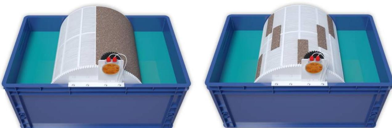
7.5 ) Через 4 часа повернуть барабаны на  $120^\circ$ . Если концентрация щавелевой кислоты достаточная вы должны увидеть разницу. Через 4 часа снова повернуть барабаны на  $120^\circ$ . Если соли и ржавчина плохо отмылись подвергните данные участки более длительному замачиванию в данном растворе.
