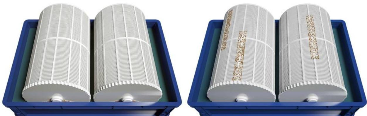
6) Через 4 часа повернуть барабаны на 120°. Если соли и ржавчина плохо отмылись, подвергнуть данные участки более длительному замачиванию в данном растворе.
