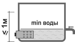
Для предотвращения последующего нагрева воды, если не требуется поддержание заданной температуры, поверните ручку терморегулятора в крайнее левое положение режим «OFF» или отключите устройство от сети. Для крепления водонагревателя к корпусу емкости используйте специальные кольца (в комплект не входят). В этом случае вам будет доступна панель управления.
